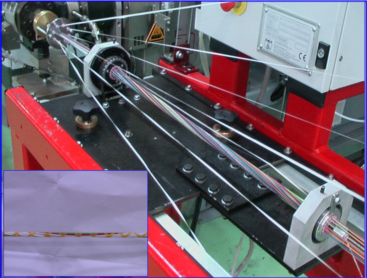
**La línea está predispuesta para reunir en paso alternado S-Z micro-cables, compuestos de fibra óptica con aislamiento TIGHT o conductores tradicionales.**
